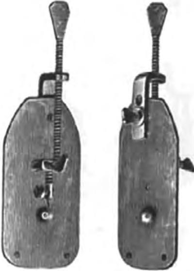
Fig. 20 A – Il microscopio di Leeuwenhoek era costituito da una piccola lente biconvessa fissata ad una lastra di rame e da un gioco di viti per spostare l'oggetto in esame per la sua messa a fuoco (16 pag. 480).
